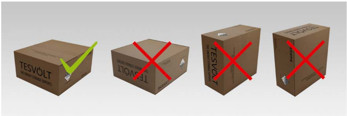
Abbildung 3.1 Zulässige und unzulässige Lagerungspositionen eines verpackten Batteriemoduls
